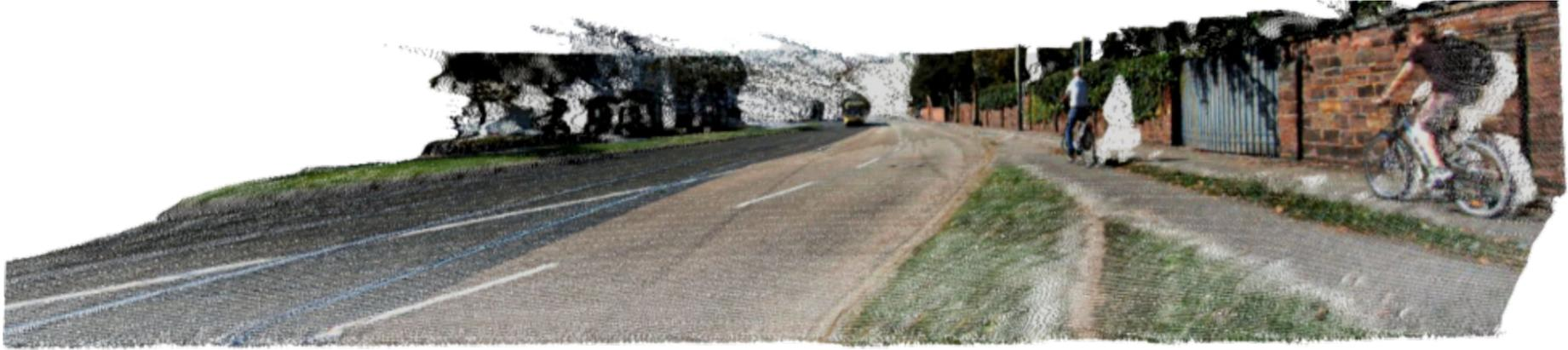
Figura 15. Visualización de una imagen RGB convertida en una representación tridimensional mediante una nube de puntos, a partir de un mapa de profundidad generado por nuestro método.
